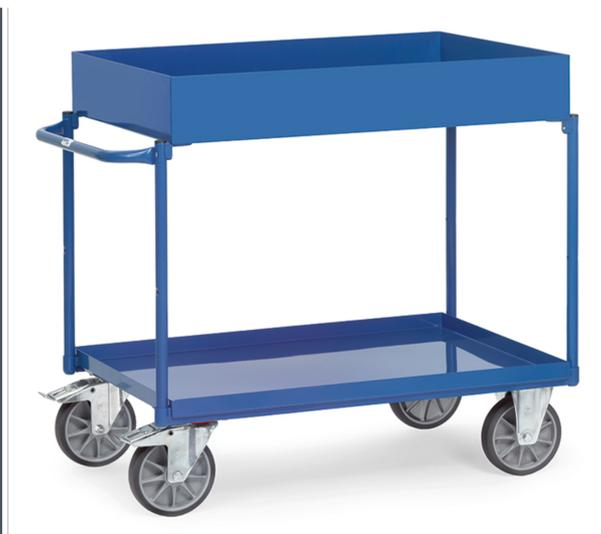
Tischwagen Stahlkonstruktion geschweißt. Mit 3 Stahlblechwannen öldicht verschweißt. Rand obere Ladefläche 150 mm hoch, Rand untere Ladefläche 40 mm hoch. Stahlrohrbügel und Stahlblechwannen werden miteinander verschraubt. Pulverbeschichtet brillantblau RAL 5007. Schiebegriff waagrecht. 2 Lenk- und 2 Bockrollen, TPE-Bereifung, Naben mit Rillenkugellager. Feststeller an den Lenkrollen, gemäß EN 1757-3 (Sicherheit von Plattformwagen). Tragkraft obere und mittlere Ladefläche 200 kg.
