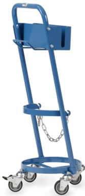
Geschweißte Stahlkonstruktion, pulverbeschichtet blau RAL 5007. Innen-Ø 310 mm. Mit Schlauch- und Schrumpfpistolenhalter. 4 Lenkrollen, 2 Stück mit Feststeller, Vollgummi-Bereifung 75 x 25 mm, Naben mit Kugellager.
