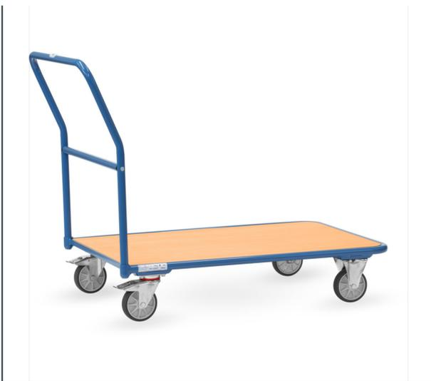
Magazinwagen aus Stahlrohr, Schweißkonstruktion, pulverbeschichtet in brillantblau RAL 5007. Plattform Holzwerkstoffplatte, Oberfläche Buchendekor. 2 Lenk- und 2 Bockrollen, TPE-Bereifung, Naben mit Rillenkugellager. Feststeller an den Lenkrollen.
