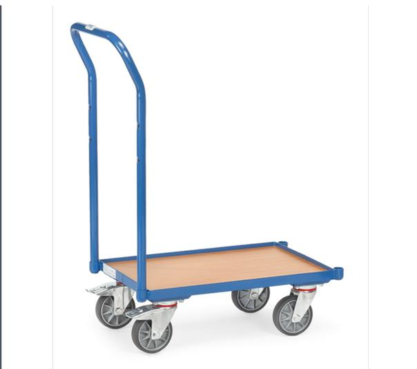
Winkelstahlkonstruktion mit Boden aus Holzwerkstoffplatte und Rohrschiebebügel, Rand 15 mm hoch.
