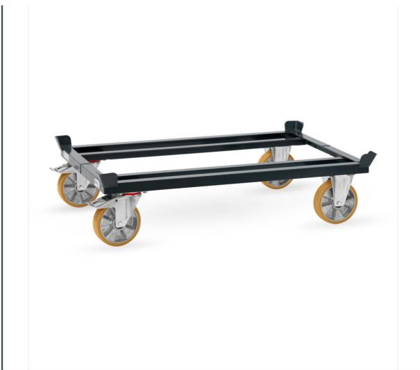
Paletten-Fahrgestell für Flachpaletten oder Gitterboxen. Robuste Winkelstahl-Schweißkonstruktion, mit 4 Fangecken, pulverbeschichtet, anthrazitgrau RAL 7016. 2 Lenk- und 2 Bockrollen, Polyurethan-Bereifung, Naben mit Kugellager, Feststeller an den Lenkrollen. Geringer Rollwiderstand, elastischer Lauf, keine Fahrgeräusche.
