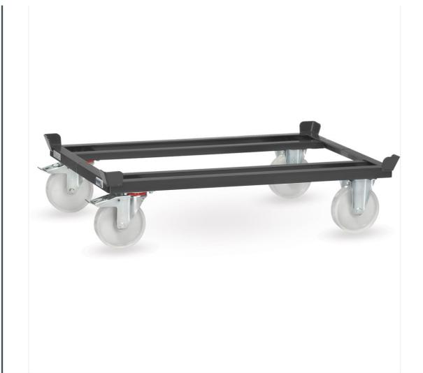
Für Flachpaletten und Gitterboxen. Robuste Winkelstahl-Schweißkonstruktion, mit 4 Fangecken, pulverbeschichtet, anthrazitgrau RAL 7016. 2 Lenk- und 2 Bockrollen, Polyamid-Räder, Naben mit Rollenlager, Feststeller an den Lenkrollen. Geringer Rollwiderstand, hohe chemische Beständigkeit, nicht kreidend = spurlos. Fahrgeräusche.
