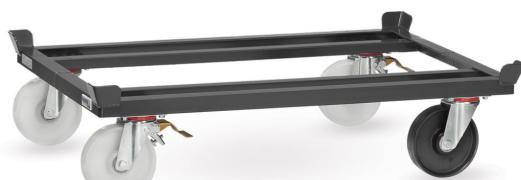
Robuste Winkelstahl-Schweißkonstruktion, mit 4 Fangecken. Pulverbeschichtet anthrazitgrau RAL 7016. 3 Lenkketten mit Polyamid-Rädern, Nabenscheiben mit Präzisionskugellager. 2 Lenkketten mit Totalfeststeller im Vorlauf, diagonal angeordnet. 1 Rolle elektrisch leitfähig, Radkörper Polypropylen schwarz, Nabe mit Präzisionskugellager. Unterfahrhöhe: 235 mm
