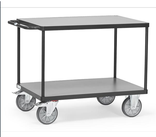
Tischwagen mit dem MultiVario Baukasten-System aus Stahlrohr und Profilstahl geschweißt, pulverbeschichtet anthrazitgrau RAL 7016. Dauerhaft oberflächengeschützt, schlag- und kratzfest. 2 Plattformen aus Holzwerkstoffplatte, Oberfläche mittelgrau. Die Systemteile werden einfach eingesteckt und festgeschraubt. 2 Lenk- und 2 Bockrollen mit TPE-Bereifung und Naben mit Rillenkugellager. Feststeller an den Lenkrollen. Tragkraft obere Ladefläche 200 kg.
