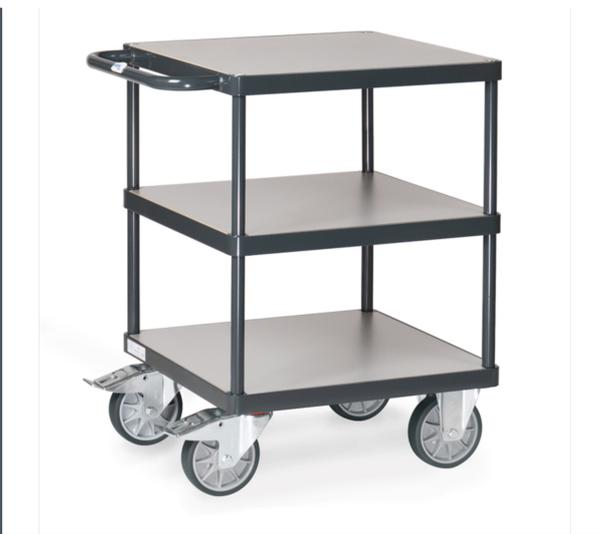
Tischwagen mit dem MultiVario Baukasten-System aus Stahlrohr und Profilstahl geschweißt, pulverbeschichtet anthrazitgrau RAL 7016. Dauerhaft oberflächengeschützt, schlag- und kratzfest. 2 Plattformen aus Holzwerkstoffplatte, Oberfläche mittelgrau. Die Systemteile werden einfach eingesteckt und festgeschraubt. 2 Lenk- und 2 Bockrollen mit TPE-Bereifung und Naben mit Rillenkugellager. Feststeller an den Lenkrollen. Tragkraft obere Ladefläche 200 kg.
