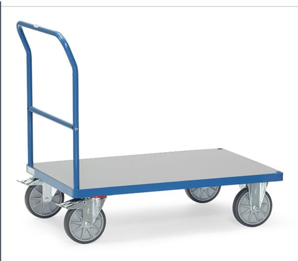
Schiebebügelwagen aus Stahlrohr und Profilstahl geschweißt, pulverbeschichtet brillantblau RAL 5007. Plattform mit Ladefläche aus Hart-PVC-Platte. Hohe Chemikalienbeständigkeit und schwer entflammbar. 2 Lenk- und 2 Bockrollen, TPE-Bereifung, Naben mit Rillenkugellager. Feststeller an den Lenkrollen, gemäß der Europäischen Norm EN 1757-3 (Sicherheit von Plattformwagen).
