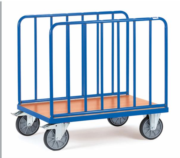
Längswandwagen aus Stahlrohr und Profilstahl geschweißt, pulverbeschichtet brillantblau RAL 5007, Plattform Holzwerkstoffplatte, Oberfläche Buchendekor. Mit 2 Rohrbügeln mit vertikalen Streben im Abstand ca. 130 mm. Wandhöhe 750 mm. 2 Lenk- und 2 Bockrollen, TPE-Bereifung, Naben mit Rillenkugellager. Feststeller an den Lenkrollen, gemäß der Europäischen Norm EN 1757-3 (Sicherheit von Plattformwagen).
