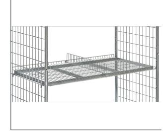
Als Fachteiler für Drahtgitterböden. Mit angeschweißten Klemmlaschen. Drahtschweißgitter galvanisch glanzverzinkt. Größe: B x H 506/606 x 95 mm Maschenweite: 25 mm
