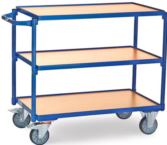
Leichter Tischwagen aus Stahlrohr und Profilstahl geschweißt, pulverbeschichtet brillantblau RAL 5007. Schraubkonstruktion. 3 Böden aus Holzwerkstoffplatte, Oberfläche Buchendekor, im Stahlrahmen liegend, Rand 12 mm hoch. Schiebegriff waagrecht. 2 Lenk- und 2 Bockrollen, TPE-Bereifung, Naben mit Rillenkugellager. Feststeller an den Lenkrollen, gemäß der Europäischen Norm EN 1757-3 (Sicherheit von Plattformwagen). Tragkraft obere und mittlere Ladefläche 80 kg.
