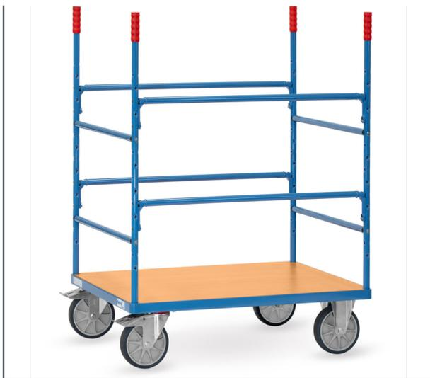
Materialwagen aus Stahrohr und Profilstahl geschweißt, pulverbeschichtet RAL 5007 brillantblau. Plattform Holzwerkstoffplatte, Oberfläche Buchendekor. Mit 4 Rungen und variabel einschraubbaren Auflagen für Langmaterialien wie Rohre, Latten uvm. 2 Lenk- und 2 Bockrollen, TPE-Bereifung, Naben mit Rillenkugellager. Feststeller an den Lenkrollen.
