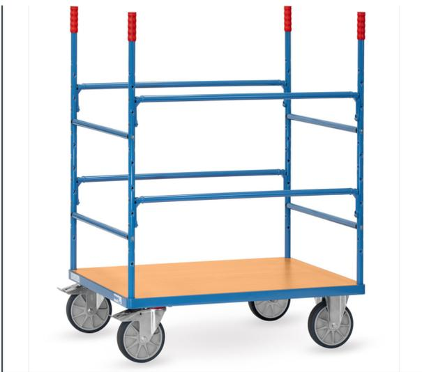
Materialwagen aus Stahrohr und Profilstahl geschweißt, pulverbeschichtet RAL 5007 brillantblau. Plattform Holzwerkstoffplatte, Oberfläche Buchendekor. Mit 4 Rungen und variabel einschraubbaren Auflagen für Langmaterialien wie Rohre, Latten uvm. 2 Lenk- und 2 Bockrollen, TPE-Bereifung, Naben mit Rillenkugellager. Feststeller an den Lenkrollen.
