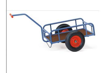
Handwagen aus Stahlrohr geschweißt, pulverbeschichtet, brillantblau RAL 5007. Geländer 180/250 mm hoch. Deichsel anschraubbar. Ladefläche aus wasserfestem Sperrholz. Räder mit Vollgummibereifung, Naben mit Rollenlager.
