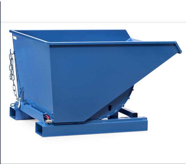
Selbstkipper müssen zum Entleeren nicht angehoben werden. Die leere Mulde geht selbsttätig in die Beladestellung zurück. Robuste Schweißkonstruktion aus 3-mm-Stahlblech, Lackierung blau RAL 5007. Serienmäßig mit Staplertaschen, Abrollsicherung und Kippverriegelung, Gliederkette als Abrutsch- und Kippsicherung. Zugseil zur Kippauslösung vom Staplersitz aus. Zusatz "A" bedeutet mit Ablasshahn und Sieb zum Trennen von Flüssigkeiten und Feststoffen.
