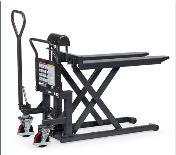
Gute Standfestigkeit, auch bei angehobener Last verfahrbar. Rahmen und Gabeln in stabiler verwindungsfreier Profilstahl-Konstruktion, pulverbeschichtet anthrazit grau RAL 7016. Kräftiger Rohr-Schiebebügel. Hydraulikpumpe mit verchromten Kolben und Überlastventil. Bedienung über Fußpedal. Senkventil über Handhebel zu betätigen. 2 Lenkrollen mit Feststeller. Ausführung zusätzlich mit einer Lenkdeichsel ausgerüstet.
