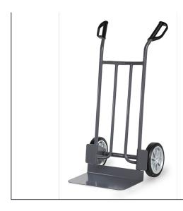
ESD-Sackkarre mit Stahlblechschaufel, stabile Schweißkonstruktion, elektrisch leitfähig pulverbeschichtet, schiefergrau RAL 7015. ESD-Sicherheitsgriffe. Stahlblechschaufel verschraubt und dadurch austauschbar. Räder mit ESD-Vollgummibereifung, auf Kunststoff-Felgen, Naben mit Rollenlagerung.
