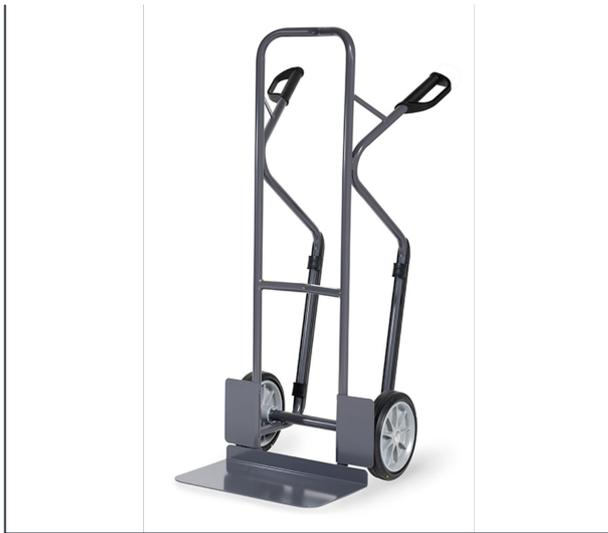
ESD-Stapelkarre mit Stahlblechschaufel, stabile Schweißkonstruktion, elektrisch leitfähig pulverbeschichtet, schiefergrau RAL 7015. ESD-Sicherheitsgriffe. Stahlblechschaufel verschraubt und dadurch austauschbar. Räder mit ESD-Vollgummibereifung, auf Kunststoff-Felgen, Naben mit Rollenlagerung. Bügel oben und Querstreben durchgebogen. Für den sicheren Transport auch von runden Gütern.
