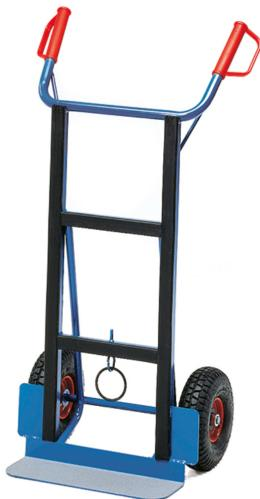
Ensemble mécano-soudé, revêtement époxy bleu RAL 5007. Diable pour le transport de poêles, réfrigérateurs, machines à laver, etc.. Large protection caoutchouc sur tablier et antidérapante sur bavette. Poignées de sécurité en plastique dur avec arceaux de sécurité. Roues gonflables, moyeu à roulement à rouleaux.
