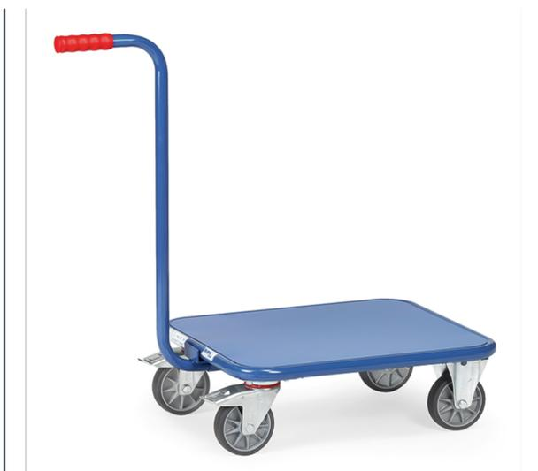
Chariot à col de cygne en tube d'acier, revêtement époxy bleu RAL 5007 avec plateau en tôle d'acier sans rebord, poignée à boulonner, 2 roues pivotantes avec freins et 2 roues fixes à bandage TPE 125 x 32 mm, moyeu à roulement à billes central.
