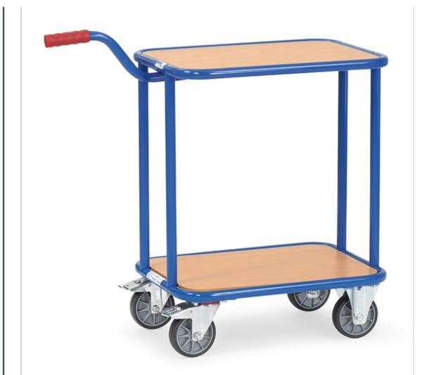
Chariot à col de cygne en tube d'acier, revêtement époxy bleu RAL 5007 avec 2 plateaux bois, poignée à boulonner, 2 roues pivotantes avec freins et 2 roues fixes à bandage TPE 125 x 32 mm, moyeu à roulement à billes central.
