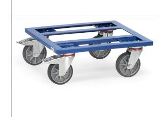
Plateau roulant en profilé d'acier avec armature ouverte, revêtement époxy bleu RAL 5007. 4 roues pivotantes à bandage TPE 125 x 32, moyeu à roulement à billes central. 2 roues avec freins.
