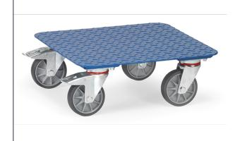
Construction soudée avec plateau en tôle antidérapant, revêtement époxy bleu RAL 5007. 4 roues pivotantes à bandage TPE 125 x 32, moyeu à roulement à billes central. 2 roues avec freins.
