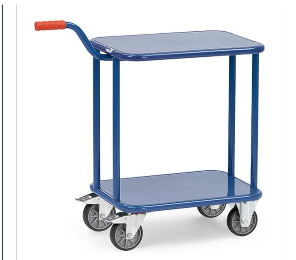
Chariot à col de cygne en tube d'acier, revêtement époxy bleu RAL 5007 avec 2 plateaux en tôle d'acier, poignée à boulonner, 2 roues pivotantes et 2 roues fixes à bandage TPE 125 x 32 mm, moyeu à roulement à billes central. Charge maximum plateau du haut: 100 kg.
