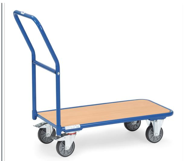
Ensemble mécano-soudé, revêtement époxy bleu RAL 5007 uniquement. Plateforme en mélaminé surface effet hêtre. 2 roues pivotantes et 2 roues fixes à bandage TPE 125 x 32, moyeu à roulement à billes central. Freins sur roues pivotantes.
