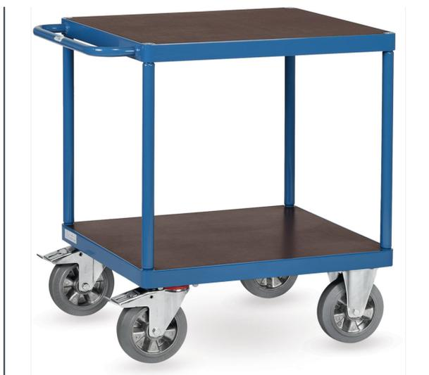
Ensemble mécano-soudé, revêtement époxy bleu RAL 5007. Plateaux carrés en aggloméré antidérapant, plastifié et hydrofuge. Chariot spécialement conçu pour transporter des charges lourdes, les roues à bandage élastique sur jantes en aluminium avec moyeu à roulement à billes permettent un déplacement aisé et confortable. 2 roues fixes et 2 roues pivotantes à bandage caoutchouc élastique, bleu-gris non traçant. Freins sur roues pivotantes. Charge plateau du haut: 500 kg.
