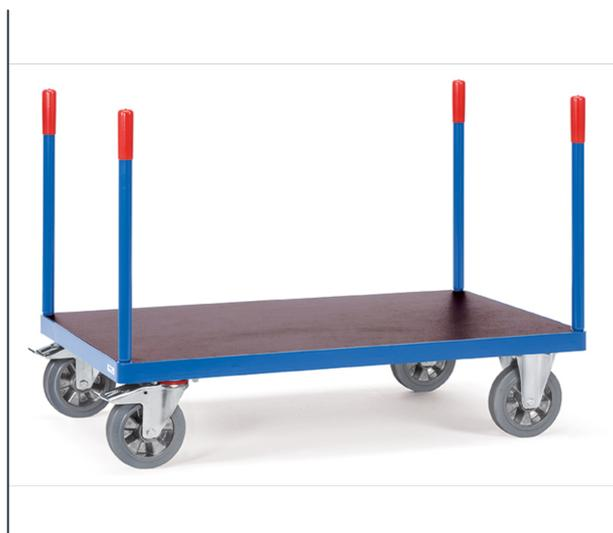
Ensemble mécano-soudé, revêtement époxy bleu RAL 5007. Plateforme en aggloméré antidérapant, plastifié et hydrofuge. 4 barres à boulonner, hauteur utile 500 mm. Chariot spécialement conçu pour transporter des charges lourdes, les roues à bandage élastique sur jantes en aluminium avec moyeu à roulement à billes permettent un déplacement aisé et confortable. 2 roues fixes et 2 roues pivotantes à bandage caoutchouc élastique, bleu-gris non traçant. Freins sur roues pivotantes.
