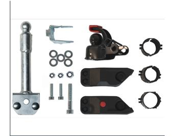
Kit galvanisé comprenant une boule d'attache un adaptateur de tige de selle de diamètre 26 à 31 mm et attache avec platines pour une fixation au timon. Charge Maxi. 40 kg pression sur attache 4 kg. Peut être monté à postériori.
