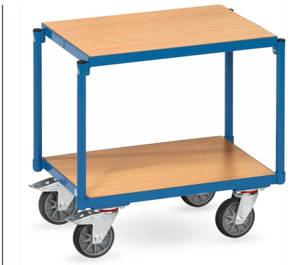
Construction en profilé d'acier, revêtement époxy bleu RAL 5007. 2 plateaux en mélaminé surface effet hêtre sans rebord, distance entre les plateaux: 400 mm. Hauteur totale: 639 mm. 4 roues pivotantes à bandage TPE, moyeu à roulement à billes central. 2 roues avec freins. Compatible pour bacs plastiques 600 x 400 mm.
