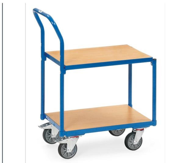
Construction en profilé d'acier, revêtement époxy bleu RAL 5007. 2 plateaux en mélaminé surface effet hêtre sans rebord et dossier de poussée, distance entre les plateaux: 400 mm. Hauteur totale: 970 mm. 4 roues pivotantes à bandage TPE, moyeu à roulement à billes central. 2 roues avec freins. Compatible pour bacs plastiques 600 x 400 mm.
