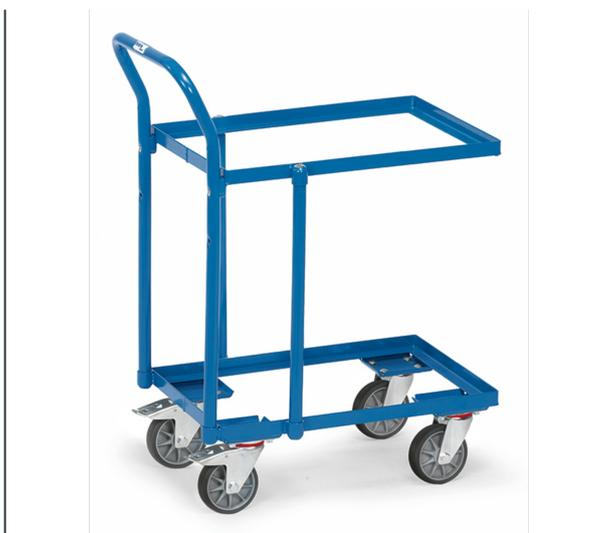
Construction en profilé d'acier, revêtement époxy bleu RAL 5007. Plateaux à armature ouverte et dossier de poussée pour le transport de bacs Norme Euro. 4 roues pivotantes à bandage TPE, moyeu à roulement à billes central. 2 roues avec freins. Compatible pour bacs plastiques 600 x 400 mm.
