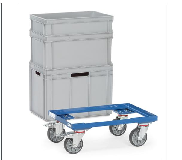
Construction en profilé d'acier, revêtement époxy bleu RAL 5007. Rouleur à armature ouverte. 4 roues pivotantes à bandage TPE, moyeu à roulement à billes central. 2 roues avec freins. Compatible pour bacs plastiques 600 x 400 mm.
