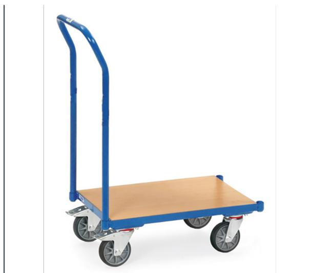
Construction en profilé d'acier, revêtement époxy bleu RAL 5007. Rouleur avec plateau en mélaminé sans rebord et dossier de poussée en tube d'acier. 4 roues pivotantes à bandage TPE, moyeu à roulement à billes central. 2 roues avec freins. Compatible pour bacs plastiques 600 x 400 mm.
