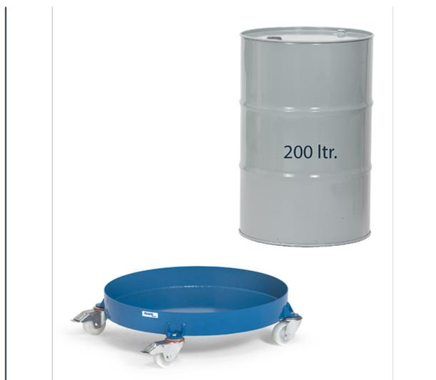
Ensemble mécano-soudé, revêtement époxy bleu RAL 5007. Rouleur pour le transport vertical de fûts en tôle contenance 200 litres. Rouleur étanche en tôle d'acier soudée. Ø interne 630 mm, rebord de 80 mm. 4 roues pivotantes dont 2 avec freins en polyamide, roulement à palier lisse.
