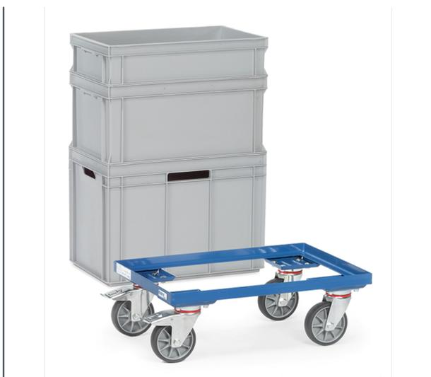
Construction en profilé d'acier, revêtement époxy bleu RAL 5007. Rouleur à armature ouverte. 4 roues pivotantes à bandage TPE, moyeu à roulement à billes central. 2 roues avec freins. Compatible pour bacs plastiques 800 x 600 mm.
