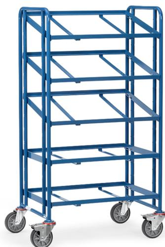
Ensemble mécano-soudé et vissé, revêtement époxy bleu RAL 5007. Plateaux amovibles dans supports réglables au pas de 100mm, inclinaison de 15° et 30°. 4 roues pivotantes à bandage TPE, moyeu à roulement à billes central. Freins sur roues pivotantes.
