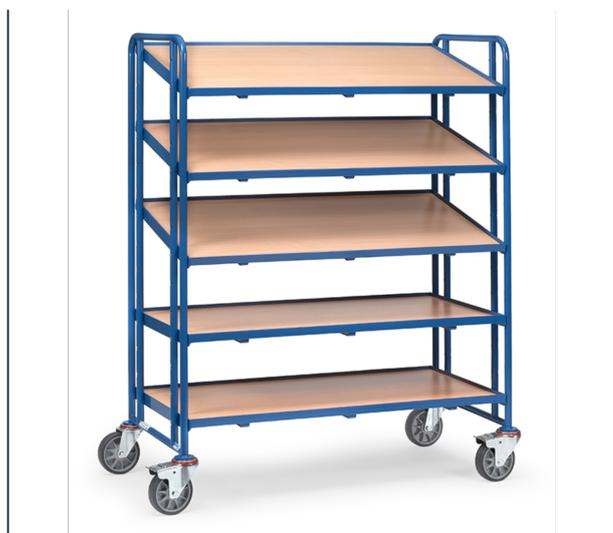
Ensemble mécano-soudé, revêtement époxy bleu RAL 5007. 5 plateaux amovibles en mélaminé surface effet hêtre avec rebord de 13 mm. Plateaux réglables au pas de 100 mm et inclinables de 15° et 30°. 4 roues pivotantes à bandage TPE, moyeu à roulement à billes. 2 roues avec freins. Charge par plateau: 80 kg.
