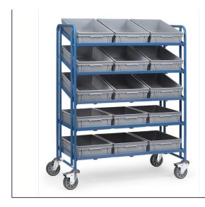
Ensemble mécano-soudé, revêtement époxy bleu RAL 5007. 5 niveaux amovibles avec armature ouverte avec 15 bacs euro 600 x 400 x 145 mm. Plateaux réglables au pas de 100 mm et inclinables de 15° et 30°. Charge par plateau 80 kg. 4 roues pivotantes à bandage TPE, moyeu à roulement à billes. 2 roues avec freins.
