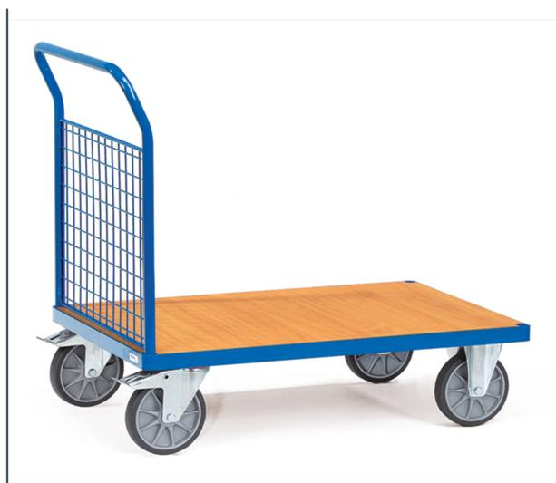
Ensemble mécano-soudé, revêtement époxy bleu RAL 5007, plateau en mélaminé surface effet hêtre avec une ridelle en treillis métallique 50 x 50 x 4 mm, hauteur 500 mm. 2 roues pivotantes et 2 roues fixes à bandage TPE, moyeu à roulement à billes central. Freins sur roues pivotantes.
