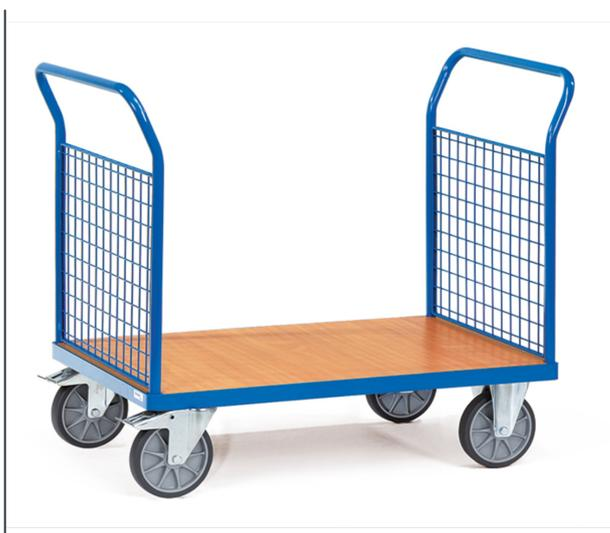
Ensemble mécano-soudé, revêtement époxy bleu RAL 5007, plateau en mélaminé surface effet hêtre avec ridelles en treillis métallique 50 x 50 x 4 mm, hauteur 500 mm. 2 roues pivotantes et 2 roues fixes à bandage TPE, moyeu à roulement à billes central. Freins sur roues pivotantes.
