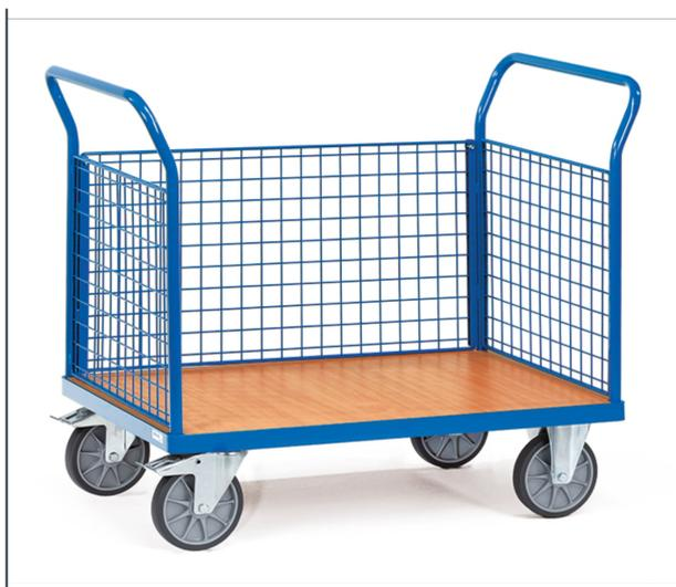
Ensemble mécano-soudé, revêtement époxy bleu RAL 5007, plateau en mélaminé surface effet hêtre avec 3 ridelles en treillis métallique 50 x 50 x 4 mm, hauteur petits et grand côtés 500 mm, grand côté boulonné. 2 roues pivotantes et 2 roues fixes à bandage TPE, moyeu à roulement à billes central. Freins sur roues pivotantes.
