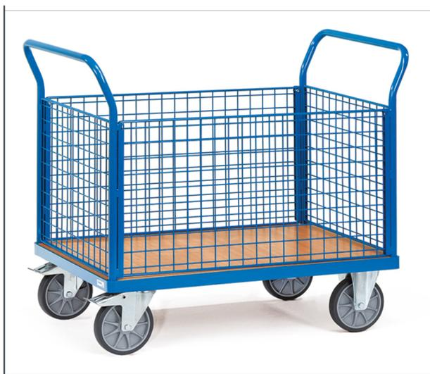
Ensemble mécano-soudé, revêtement époxy bleu RAL 5007, plateau en mélaminé surface effet hêtre avec 4 ridelles en treillis métallique 50 x 50 x 4 mm, hauteur petits et grands côtés 500 mm, grands côtés amovibles dont un boulonné. 2 roues pivotantes et 2 roues fixes à bandage TPE, moyeu à roulement à billes central. Freins sur roues pivotantes.
