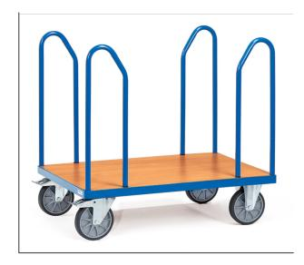
Ensemble mécano-soudé, revêtement époxy bleu RAL 5007, plateau en mélaminé surface effet hêtre avec arceaux latéraux en tube, hauteur 750 mm. 2 roues pivotantes et 2 roues fixes à bandage TPE, moyeu à roulement à billes central. Freins sur roues pivotantes.
