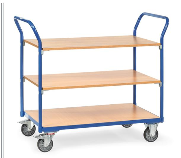
Ensemble mécano-soudé en tube d'acier, revêtement époxy bleu RAL 5007. Plateforme en mélaminé surface effet hêtre. Plateaux du haut et du milieu amovibles. 2 roues pivotantes et 2 roues fixes à bandage TPE, moyeu à roulement à billes central. Freins sur roues pivotantes. Charge plateau du haut et milieu 80 kg.
