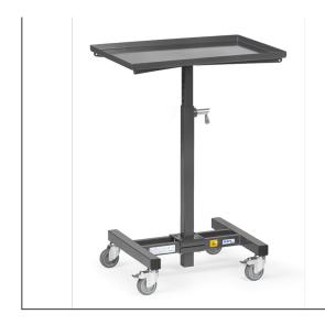
Version électriquement conductrice. Pour bacs en plastique, bacs en tôle d'acier, corbeilles en fil métallique, etc., réglable en hauteur et mobile. Construction en profilé et tube d'acier avec plateau en tôle avec rebord de 20 mm. Non inclinable. Hauteur réglable au pas de 25 mm. Revêtement époxy gris ardoise RAL 7015. 4 roues pivotantes à bandage TPE-ESD, roulement à palier lisse. 2 roues avec freins.
