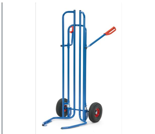
Construction en tube d'acier, revêtement époxy bleu RAL 5007. Spécialement conçu pour le transport de pneumatiques. Les fourches articulées en tube d'acier permettent d'embarquer jusqu'à 8 roues sans les empiler manuellement. Compatible pour Ø de 450 à 750 mm. Adapté pour le transport de roues avec jantes. Roues gonflables, moyeu à roulement à rouleaux.
