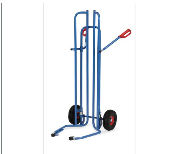
Construction en tube d'acier, revêtement époxy bleu RAL 5007. Spécialement conçu pour le transport de pneumatiques. Les fourches articulées en tube d'acier permettent d'embarquer jusqu'à 8 roues sans les empiler manuellement. Les rouleaux de démarrage à l'extrémité des fourches articulées soutiennent et facilitent le processus. Compatible pour Ø de 450 à 750 mm. Adapté pour le transport de roues avec jantes. Roues gonflables, moyeu à roulement à rouleaux.
