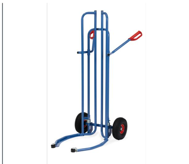
Construction en tube d'acier, revêtement époxy bleu RAL 5007. Spécialement conçu pour le transport de pneumatiques. Les fourches articulées en tube d'acier permettent d'embarquer jusqu'à 8 roues sans les empiler manuellement. Les rouleaux de démarrage à l'extrémité des fourches articulées soutiennent et facilitent le processus. Compatible pour Ø à partir de 450 à 860 mm. Adapté pour le transport de roues avec jantes. Roues gonflables, moyeu à roulement à rouleaux.
